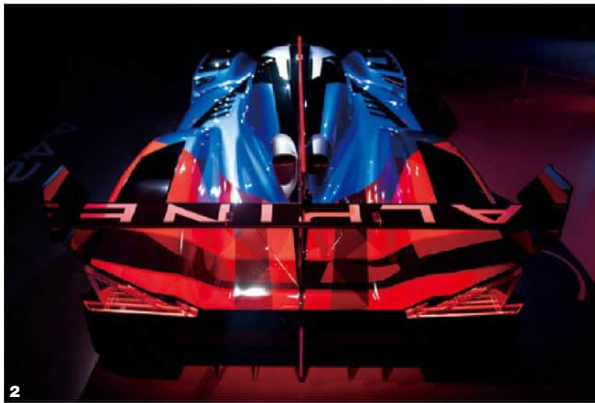
1|2 6月9日、アルピーヌが発表した新型LMDh車両は「アルピーヌA424_β」とネーミングされた。メカクローム社製の3.4ℓ V6シングルターボにポッシュ製電気モーター、ウィリアムズ製バッテリー、Xトラック製ミッション(いずれもLMDh規定)を組み合わせる。3| マスタングGT3はフォードと関係の深いマルチマチック社およびMスポーツと共同で開発を進める車両で、5.7ℓ V8エンジンにカーボンファイバー製ボディを組み合わせた仕様となっている。
