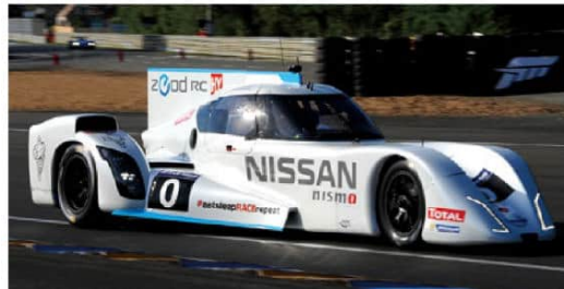
2014 | ニッサンZEOD RC Nissan ZEOD RC (エントラント:Nissan Motorsports Global) 「走る三角錐」は電気とエンジンを併用
