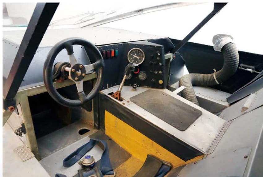
アルミパネルとスチール角材で仕立てられたコックピットの居住性は悪そう(左右の視認性は良さそう)。シートの隣にトランスミッションが置かれ、フットボックスのすぐ横にエンジンがあるという構造。
