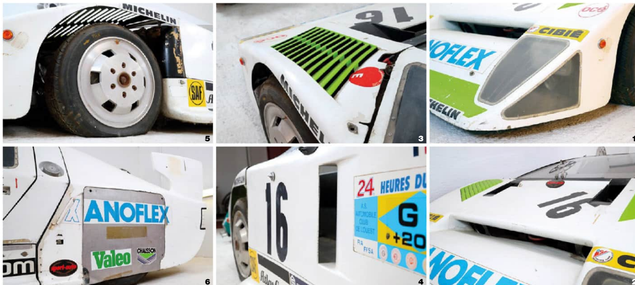
1ヘッドライト照射範囲拡大のためか、ノーズ両端までクリアになっている。2ラジエーターにエアを導くスリットは極端に薄い。3フロントタイヤフェンダー上部のルーバー。4タイヤハウス内の乱流を整えて後部へ流すため(と思われる)エアアウトレット。5グループ5レースでBMWが多く履いていた、タイヤとリムが一体設計というミシュランTRXを履く。エアロディスクホイールは……まさか6穴式!? 6最高速向上を狙ったリヤタイヤのスパッツはノンオリジナルのようで、金属製に改められていた。
