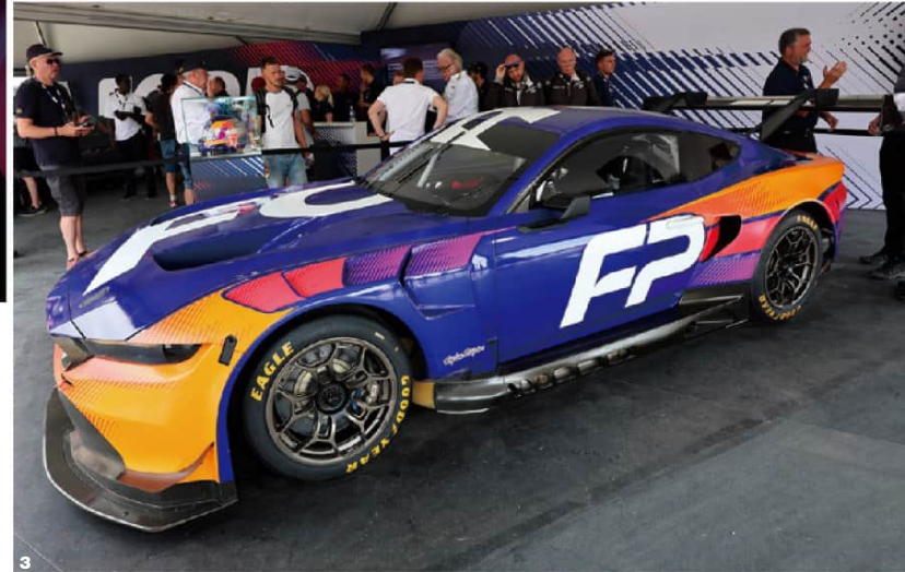
1|2 6月9日、アルピーヌが発表した新型LMDh車両は「アルピーヌA424_β」とネーミングされた。メカクローム社製の3.4ℓ V6シングルターボにポッシュ製電気モーター、ウィリアムズ製バッテリー、Xトラック製ミッション(いずれもLMDh規定)を組み合わせる。3| マスタングGT3はフォードと関係の深いマルチマチック社およびMスポーツと共同で開発を進める車両で、5.7ℓ V8エンジンにカーボンファイバー製ボディを組み合わせた仕様となっている。
